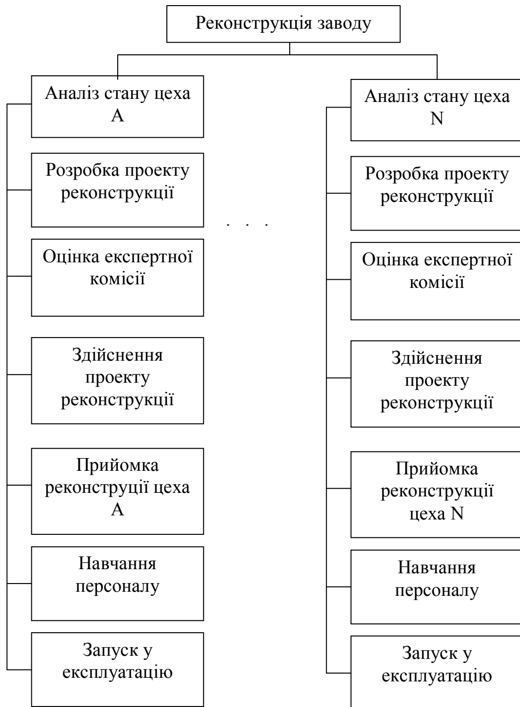
Рис. 5.3. Приклад структуризації робіт проекту з реконструкції заводу
